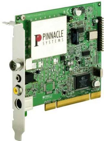
Figura 3.3.- Tarjeta capturadora de video PINNACLE PCTV
